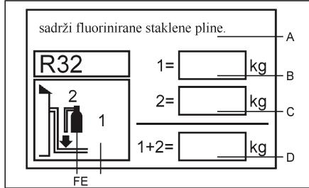
proizvod sadrži fluorirani staklenički plinovi. Ne opustite u atmosferu.
