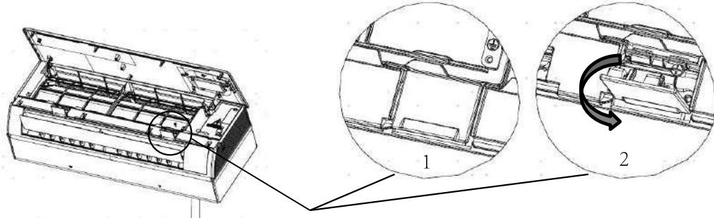
2. Zakrenite klapnu, uhvatite donji dio kućišta na krajevima i maknite ga.
