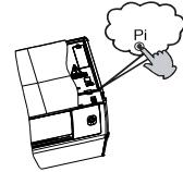
•Kada se pritisne prekidač za rad u slučaju nužde, začuće se jedan zvučni signal "Pi" što znači početak ovog načina rada.
