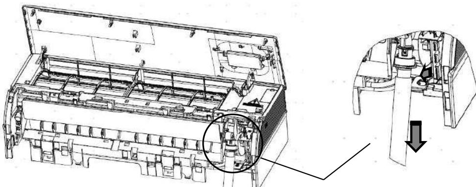
4. Otvorite kopču "A" do prikazanog kuta, a zatim otvorite kopču "B" da bi ste izvukli turbinu i motor.
