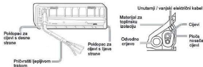
• unutarnji / vanjski električni kabel i odvodno crijevo moraju biti pričvršćeni uz cijev rashladnog medija zaštitnom trakom.
