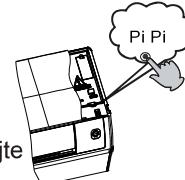
•Upotrebite ovaj prekidač za test način rada kada je sobna temperatura ispod 16°C,nemojte ga koristiti pri normalnim uvjetima.
